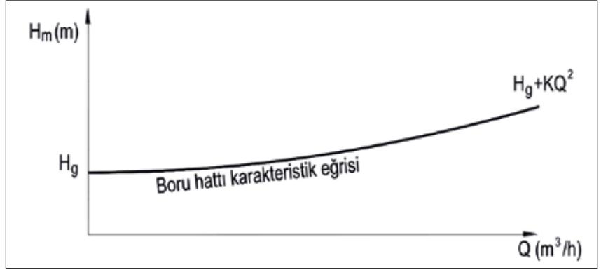
Şekil 3. Depo ve Boru hattı karakteristik eğrisi
